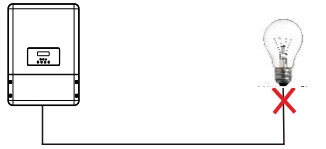
Yük ve Invertör arası Hatalı Bağlantı
