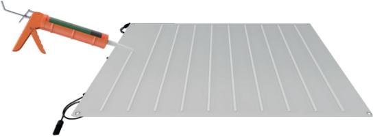
•Bei der Montage des flexiblen Moduls sollte darauf geachtet werden, dass sich keine Luft zwischen der Oberfläche und dem flexiblen Modul einschließt. Wenn sich die Luft erwärmt, erhöht sich ihr Druck, was zum Aufquellen des flexiblen Moduls führen kann. Dadurch können die Zellen zerbrechen,
