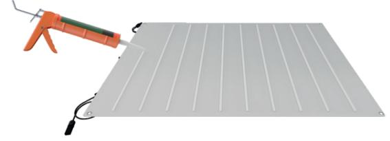
•Esnek panellerin yüzeye montajı yapılırken yüzey ile esnek panel arasında hava hapsolmemesine dikkat edilmelidir. Hava ısındığında basıncı artacak güneş panelinin olası şişmesine neden olacaktır. Bu da hücrelerin kırılmasına yol açacaktır.
