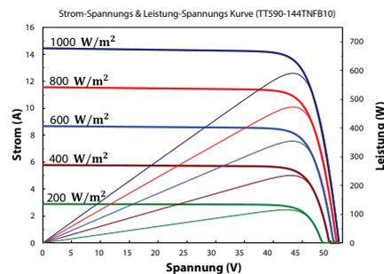
\* Die Spezifikationen wurden unter den Standardtestbedingungen (STC) gemessen: 1000 W/m<sup>2</sup> Sonneneinstrahlung, 1,5 Luftmasse und 25°C Zelltemperatur. Die Messunsicherheit für alle Panels beträgt 6%. Die tatsächlichen Parameter unterliegen den individuellen Verträgen. Diese Parameter dienen nur als Referenz und sind nicht Bestandteil der Verträge. Die technischen Spezifikationen in diesem Dokument können variieren. Weitere Informationen finden Sie in der "Installationsanleitung".
