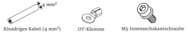
Schritt 2. Die Isolierung des Erdungskabels (Länge „L2“) abisolieren, das abisolierte Kabel in die OT-Klemme einführen und dann festklemmen.
