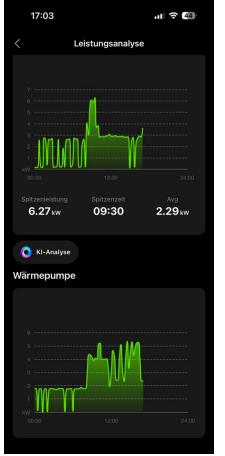
Wenn Sie auf das Wärmepumpensymbol klicken, können Sie die aktuelle Leistungsdatenanzige der Wärmepumpe sehen.
