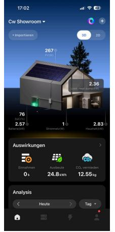
Auf der Startseite können Sie die Leistungsdaten der Wärmepumpe dynamisch einsehen.
