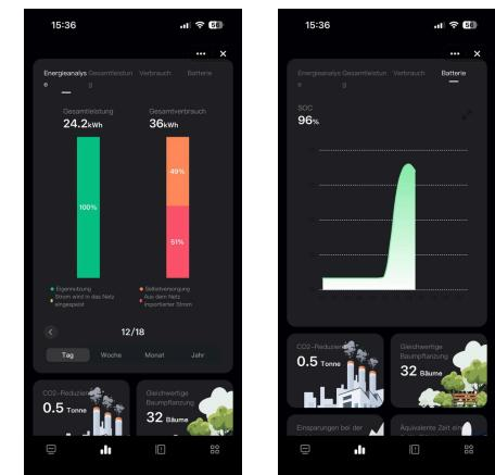
Über die Registerkarte „Grafik“ können Sie auf detaillierte Grafiken zu Energieanalyse, Gesamtleistung, Selbstversorgung und Batterie-SOC-Daten zugreifen.
