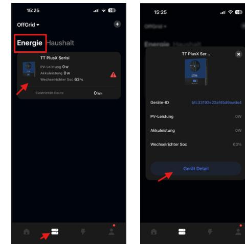
Im Bereich „Energiegeräte“ können Sie über die Gerätekarte wichtige Informationen zum Wechselrichter einsehen und durch Anklicken der Gerätedetails zur Geräteoberfläche gelangen.
